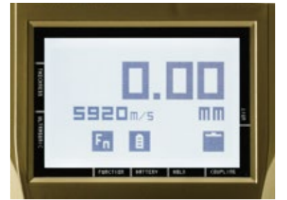
UTM-210は1/100mmの高精度計測が可能。
